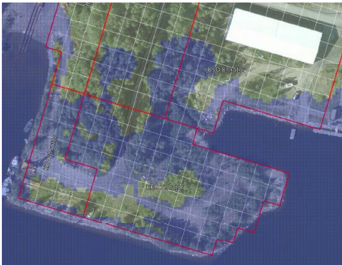
Figur 4.2. Nivån för högsta högvatten, + 1,54 i höjsystem RH2000, är färgad blå för landområden.
