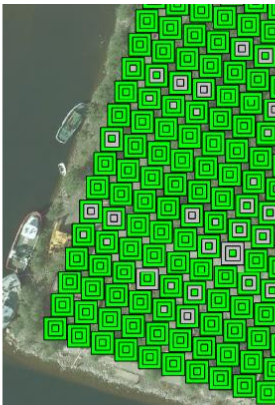
Figur 8.21. Observerade förhållanden vid provtagning för aska/kolrester, grå färg innebär att något benämns som aska/kol i anmärknings kolumnen. Observationer framgår för 3 pallar (fyrkantens storlek ökar med djupet), d v s 0 - 1,5m, i varje punkt.
