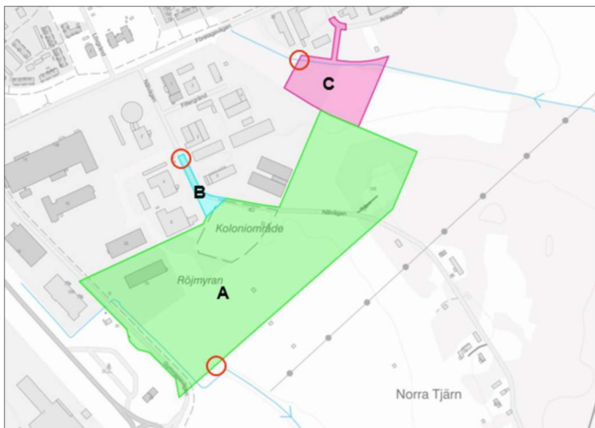
Figur 7: Kartbild som visar avrinningsområden (A-C) och avtappningspunkter (röda ringar), bild tagen ur Dagvattenutredning 2024-05-03, Tyréns.
