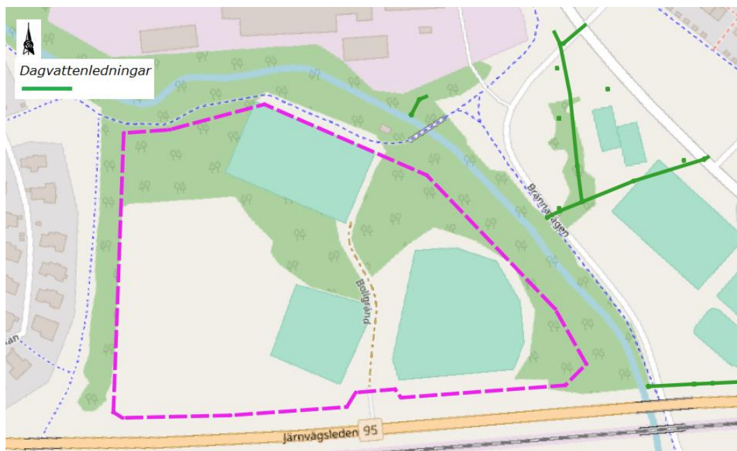
Figur 3-7. Befintligt dagvattennät i närhet till planområdet ses i gröna linjer. Planområdet är markerat med streckad magenta linje (SCALGO, 2023).
