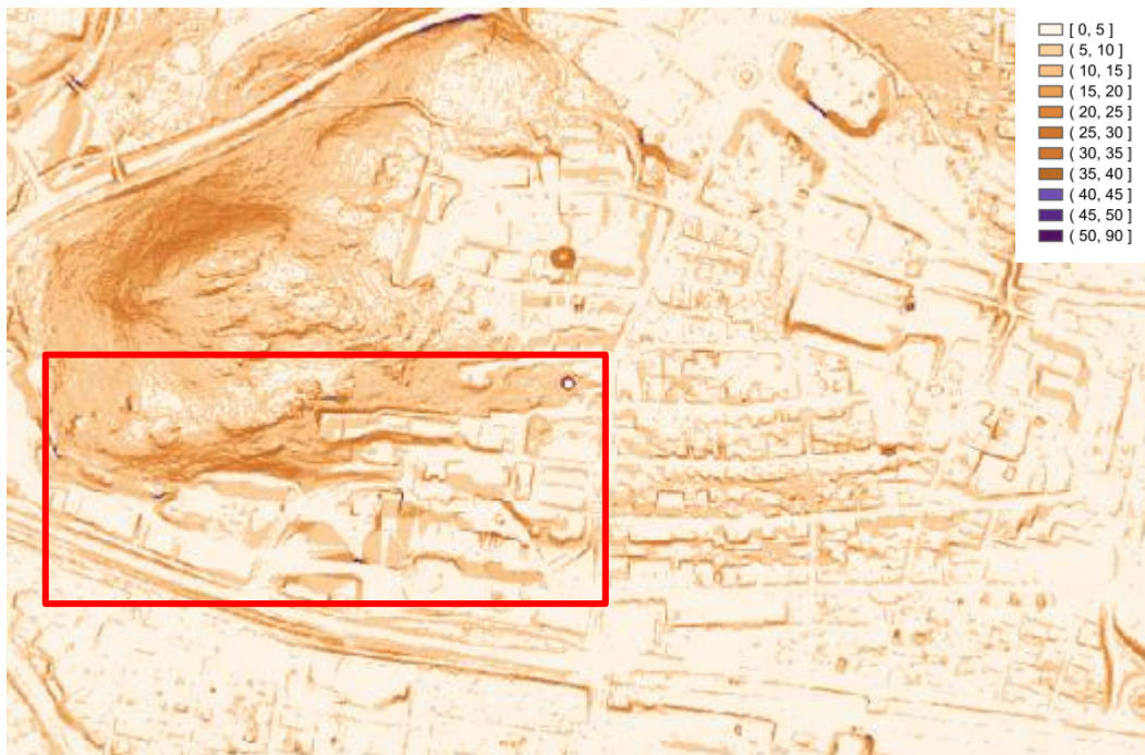
Figur 6.2.1 Översiktlig karta från SGI över terränglutning baserad på nationella höjdmodellen. Ungefärligt planområde markerat i rött.
