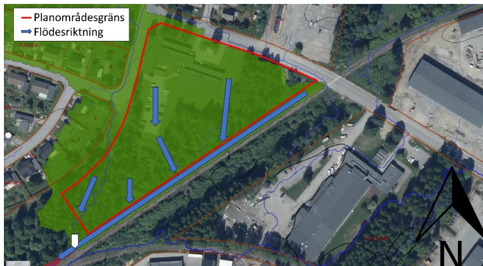
Figur 14. Grön polygon visar flöden uppströms vita markör. Hela planområdets avrinning vid kraftigare regn leds ner mot vita markören, flödet leds sedan vidare till Skellefteälven.
