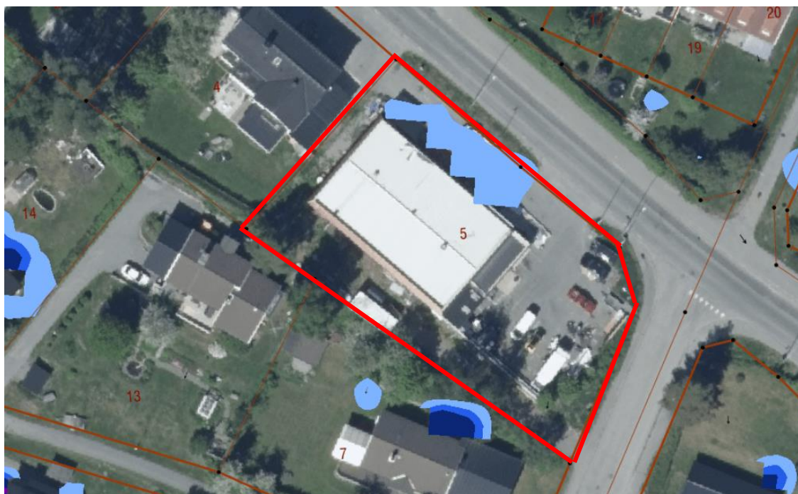
Figur 4: Skyfallskarta som visar vattensamlingar på fastigheten vid ett 100-årsregn. Planområdet är inringat med rött.
