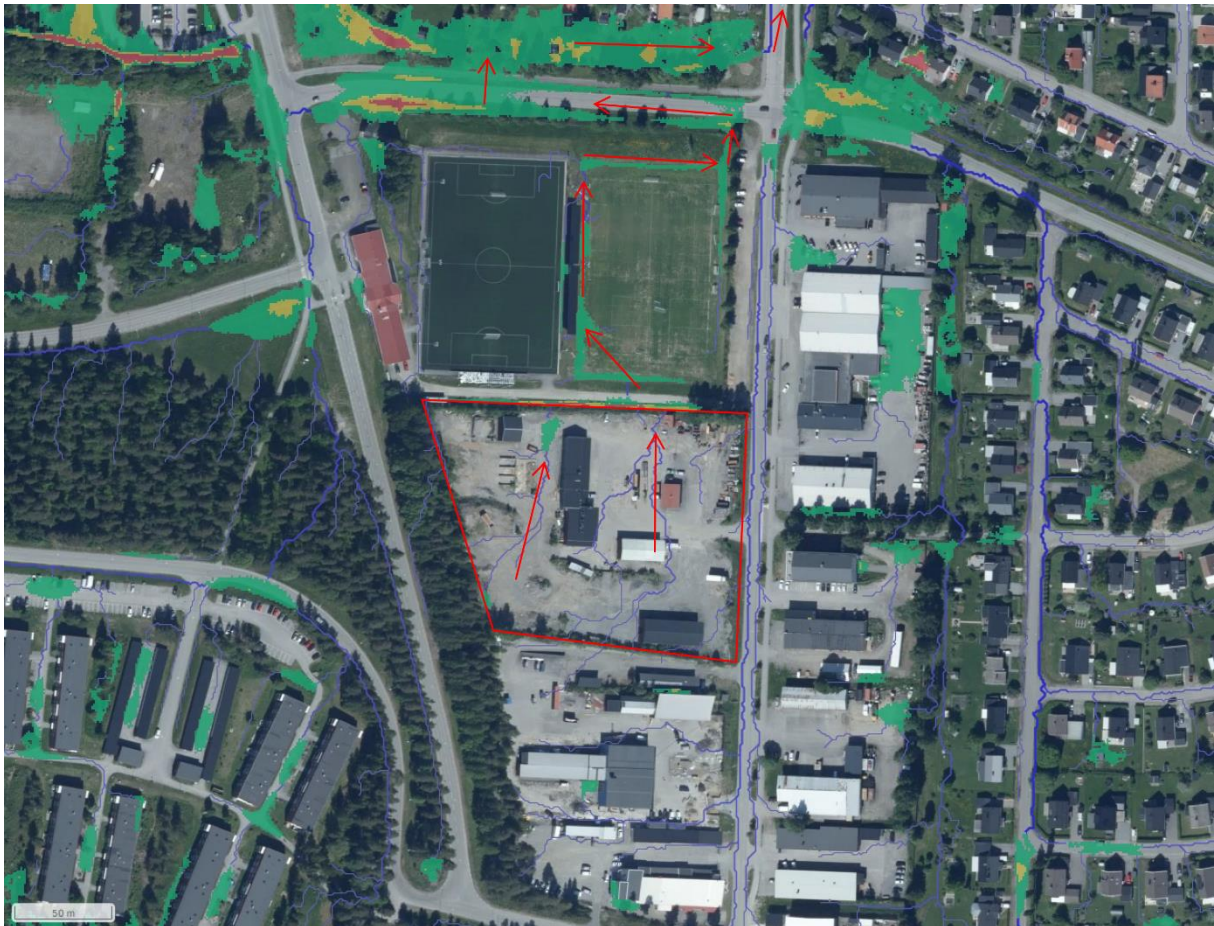
Figur 12. Vattenfyllda lågpunkter och rinnvägar inom planområdet vid befintlig höjdsättning. Baserat på ett 100-årsregn med en nederbördsmängd om 56 mm, en varaktighet på 30 minuter samt en klimattfaktor på 1,3. Gröna områden avser vatten djup < 0,3 m, gula områden avser vattendjup 0,3 – 0,5 m och röda områden avser vattendjup > 0,5 m. Utan hänsyn till ledningsnät.
