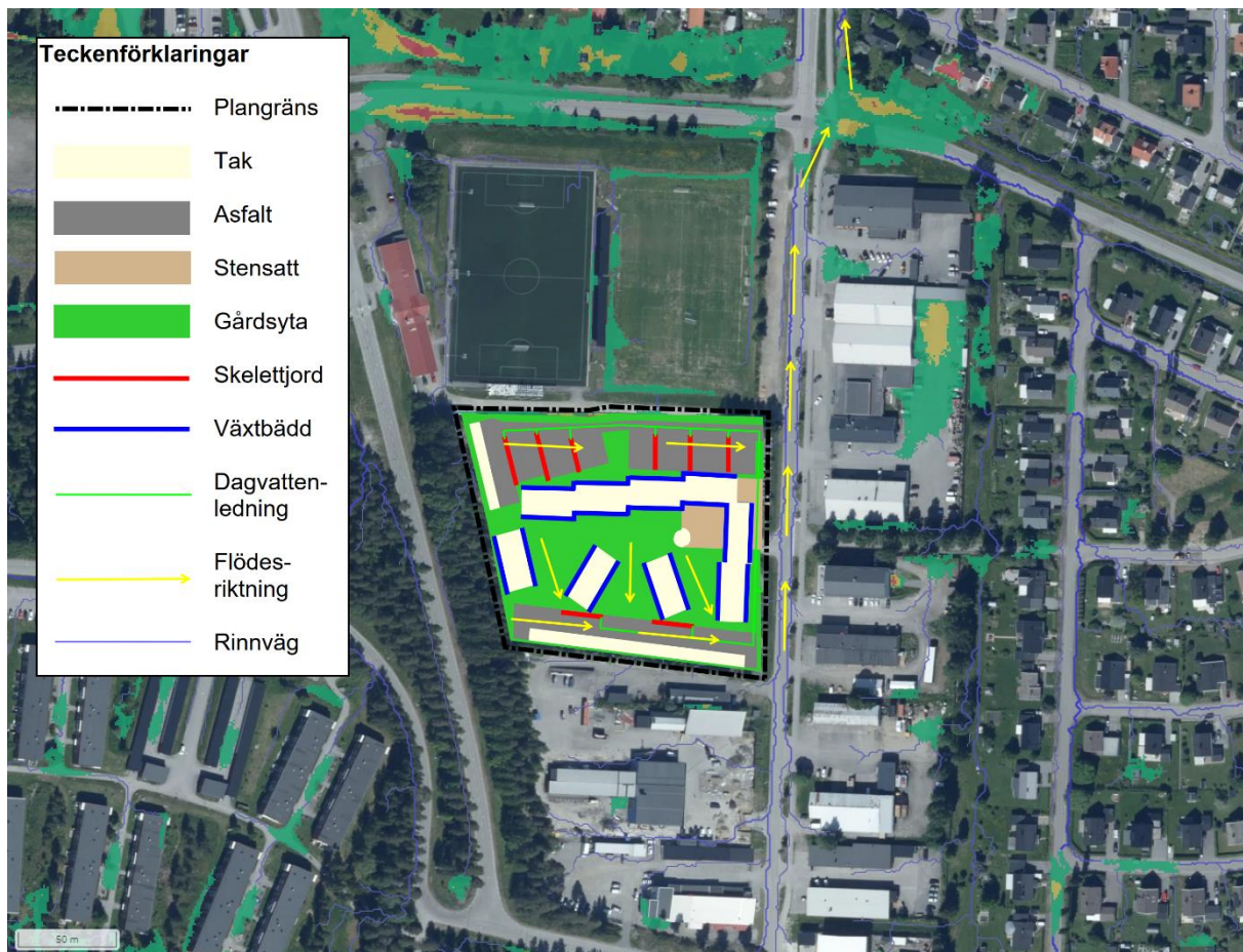
Figur 24. Vattenfyllda lågpunkter och rinnvägar inom planområdet vid framtida höjdsättning. Baserat på ett 100-årsregn med en nederbörds mängd om 56 mm, en varaktighet på 30 minuter samt en klimatfaktor på 1,3. Gröna områden avser vatten djup < 0,3 m, gula områden avser vattendjup 0,3 – 0,5 m och röda områden avser vattendjup > 0,5 m.
