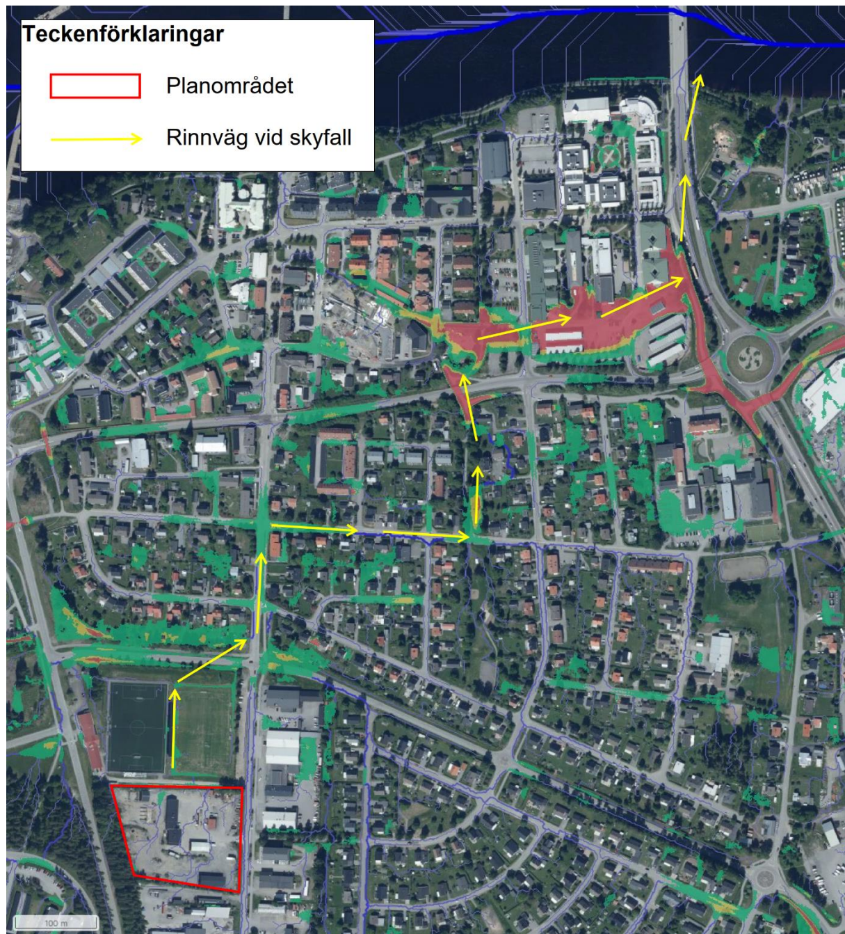
Figur 13. Vattenfyllda lågpunkter och rinnvägar inom planområdet vid befintlig höjdsättning. Baserat på ett 100-årsregn med en nederbörds mängd om 56 mm, en varaktighet på 30 minuter samt en klimatfaktor på 1,3. Gröna områden avser vattendjup < 0,3 m, gula områden avser vattendjup 0,3 – 0,5 m och röda områden avser vattendjup > 0,5 m. Utan hänsyn till ledningsnät.
