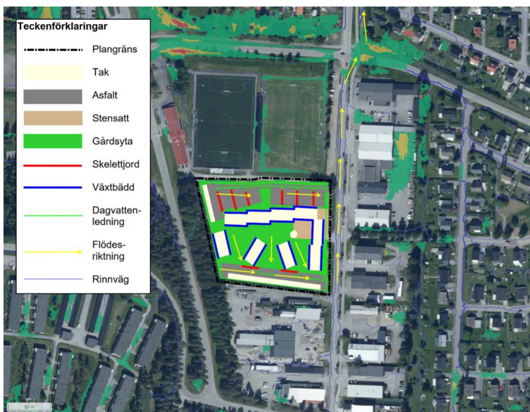
Figur 13. Vattenfyllda lågpunkter och rinnvägar inom planområdet vid framtida höjdsättning. Baserat på ett 100-årsregn med en nederbördsmängd om 56 mm, en varaktighet på 30 minuter samt en klimatfaktor på 1,3. Gröna områden avser vatten djup < 0,3 m, gula områden avser vattendjup 0,3 – 0,5 m och röda områden avser vattendjup > 0,5 m Källa: WSP
