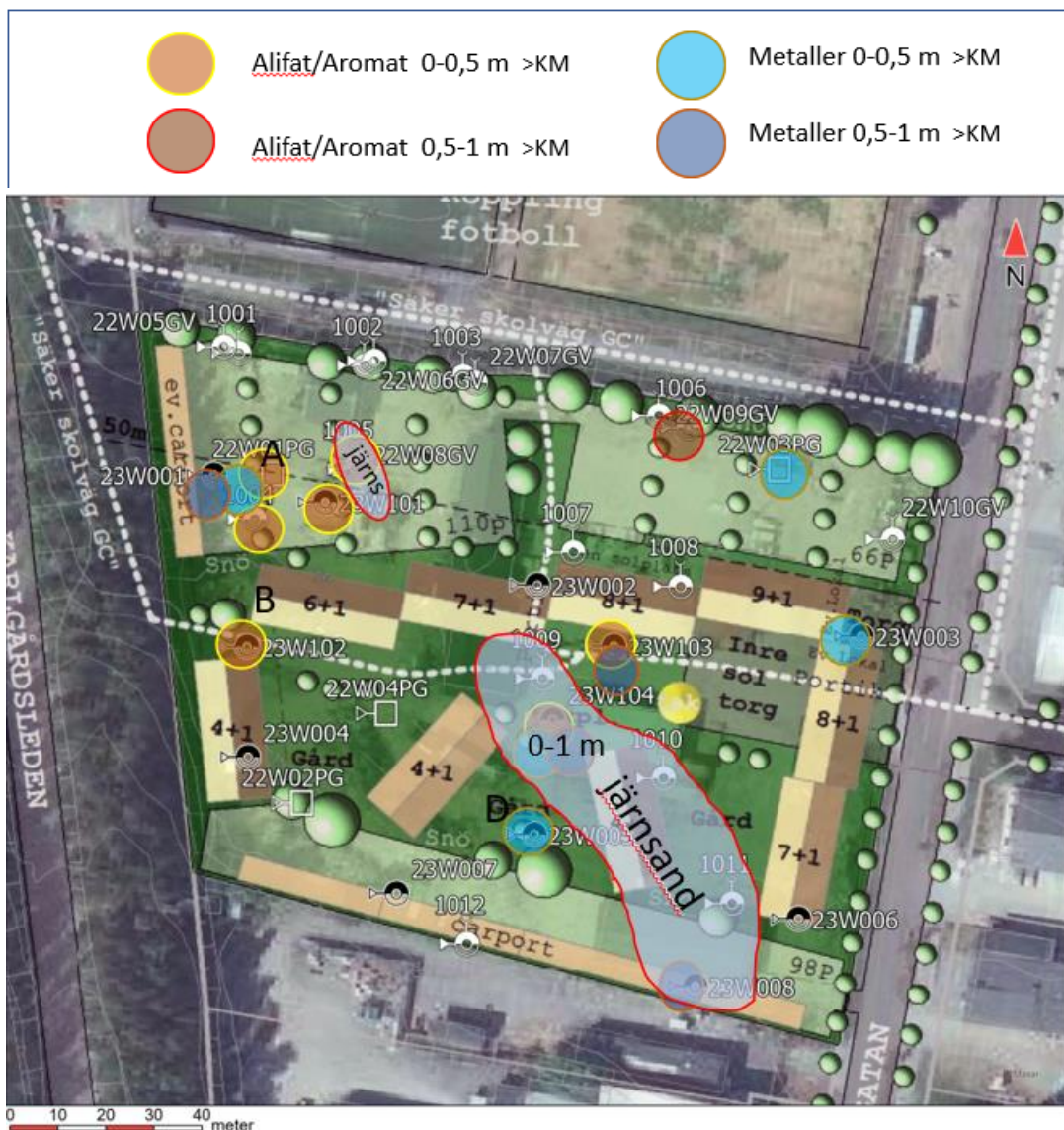
Figur 13. Sammanfattande figur med läget av analyserade prover (0-1m) som överskrider bakgrundshalter för arsenik (20mg/kg) och generella riktvärden för KM för övriga ämnen. Skattat läge av kartlagda områden med järnsand. Areorna i bilden utgör ca 1900 m 2 .
