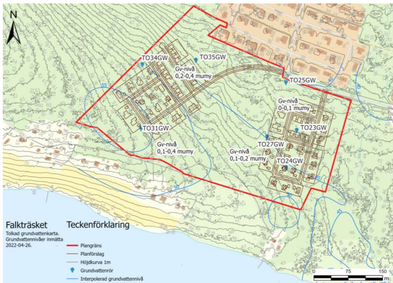
Figur 4. Interpolerade grundvattennivåer (blå linjer) i Falkträsket utifrån uppmätta värden 2022-04-26. Grå linjer är höjdkurvor från höjdmodell i Scalgo LIVE (Dagvattenutredning, Falkträsket etapp 2, 2022-11-28, Sweco AB).
