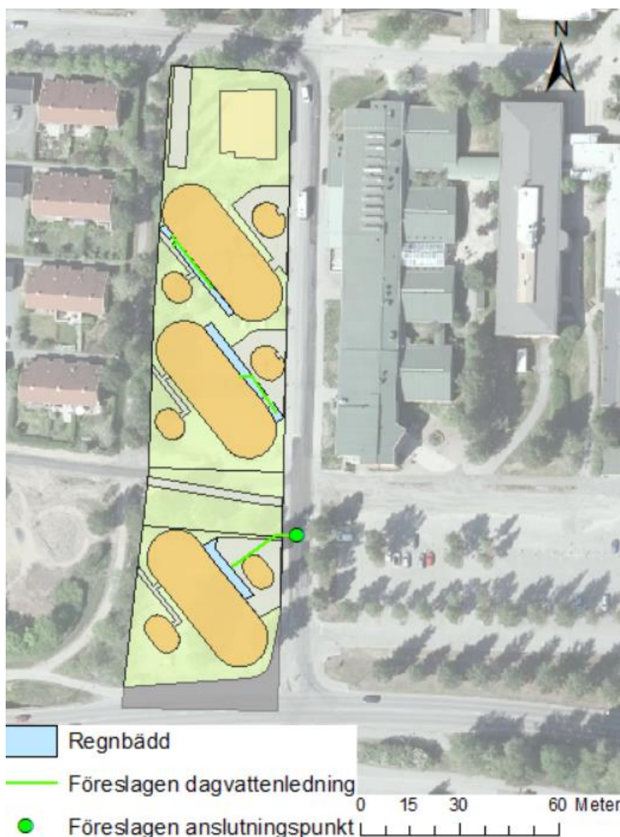
Figur 15. Exempel på placering av regnbäddar och dagvattenledningar.
