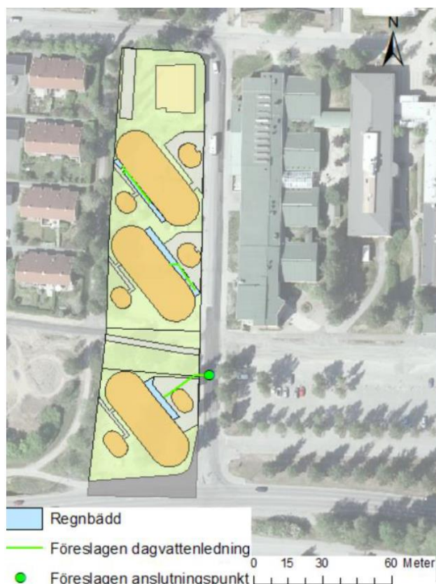
Bild 12. Exempel på placering av regnbäddar och dagvattenledningar.
