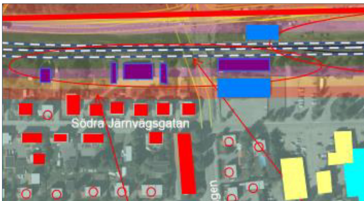
Figur 18: Översiktlig karta över bebyggelse som ligger inom riskhanteringsavståndet 150 meter. Kvarteret Göta är beläget norr om Södra Järnvägsgatan i västra delen av kartbilden. Källa: PM Risk Järnvägsplan 07, Trafikverket.
