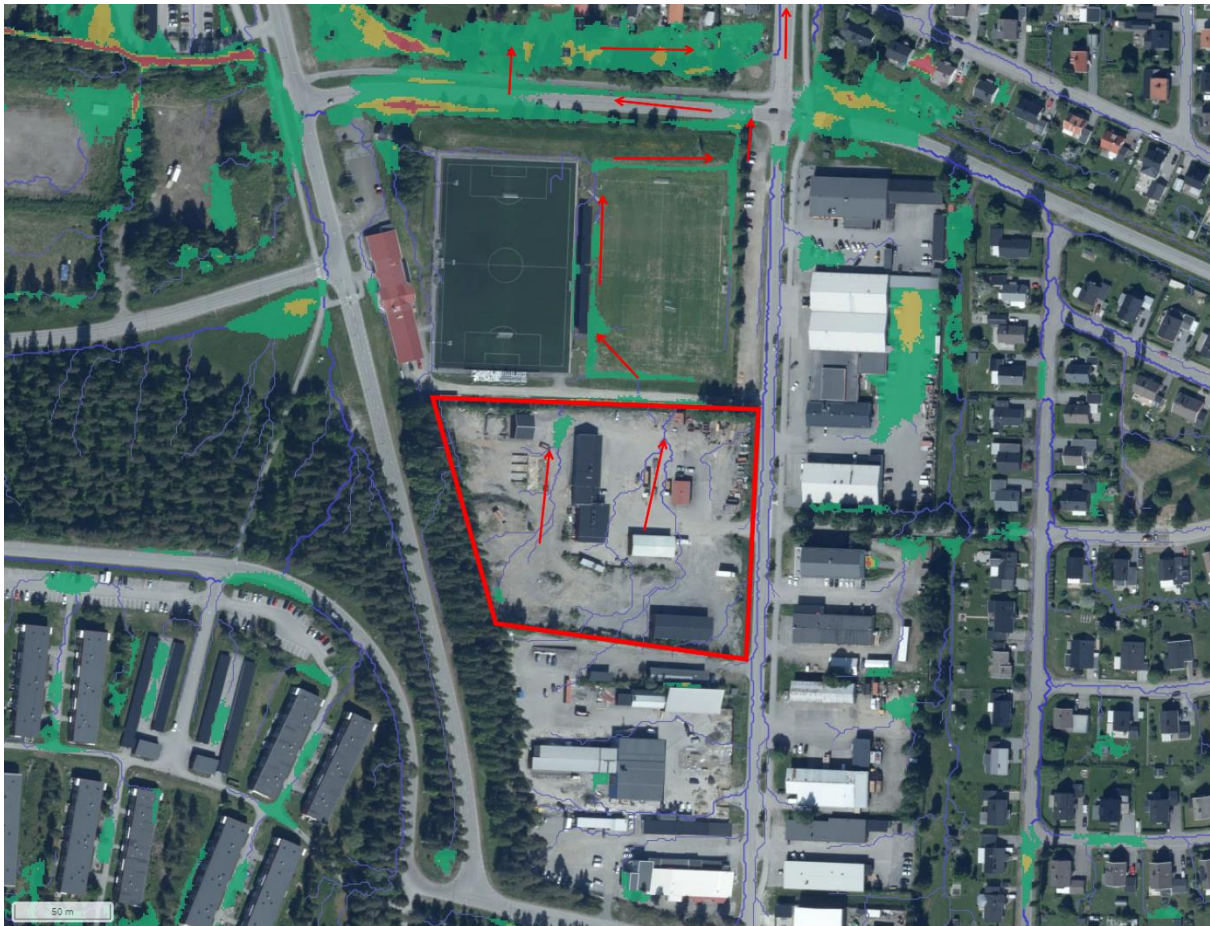
Figur 11. Vattenfyllda lågpunkter och rinnvägar inom planområdet vid befintlig höjdsättning. Baserat på ett 100-årsregn med en nederbörds mängd om 56 mm, en varaktighet på 30 minuter samt en klimatfaktor på 1,25. Gröna områden avser vatten djup < 0,3 m, gula områden avser vattendjup 0,3 – 0,5 m och röda områden avser vattendjup > 0,5 m. Utan hänsyn till ledningsnät.
