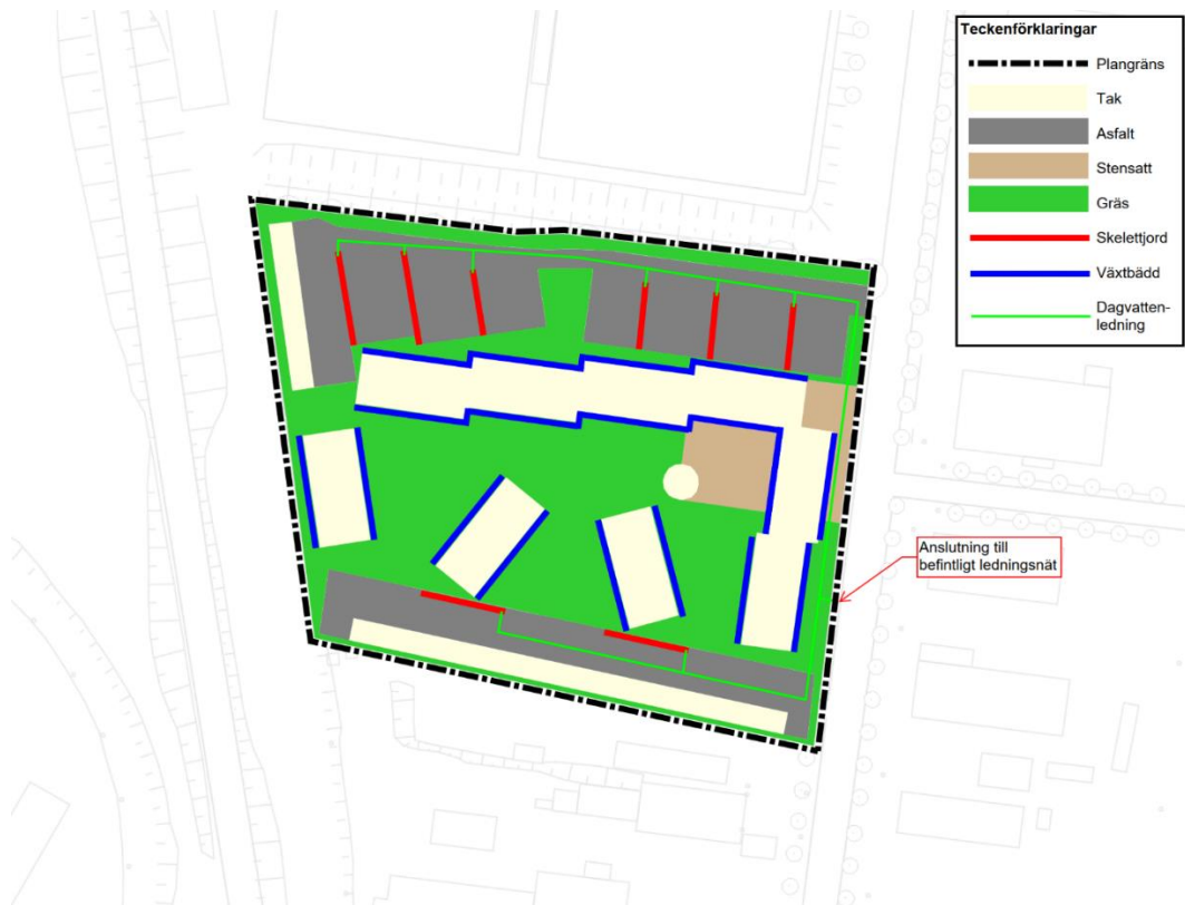
Figur 21. Lösningförslag för dagvattenhantering inom planområdet.
