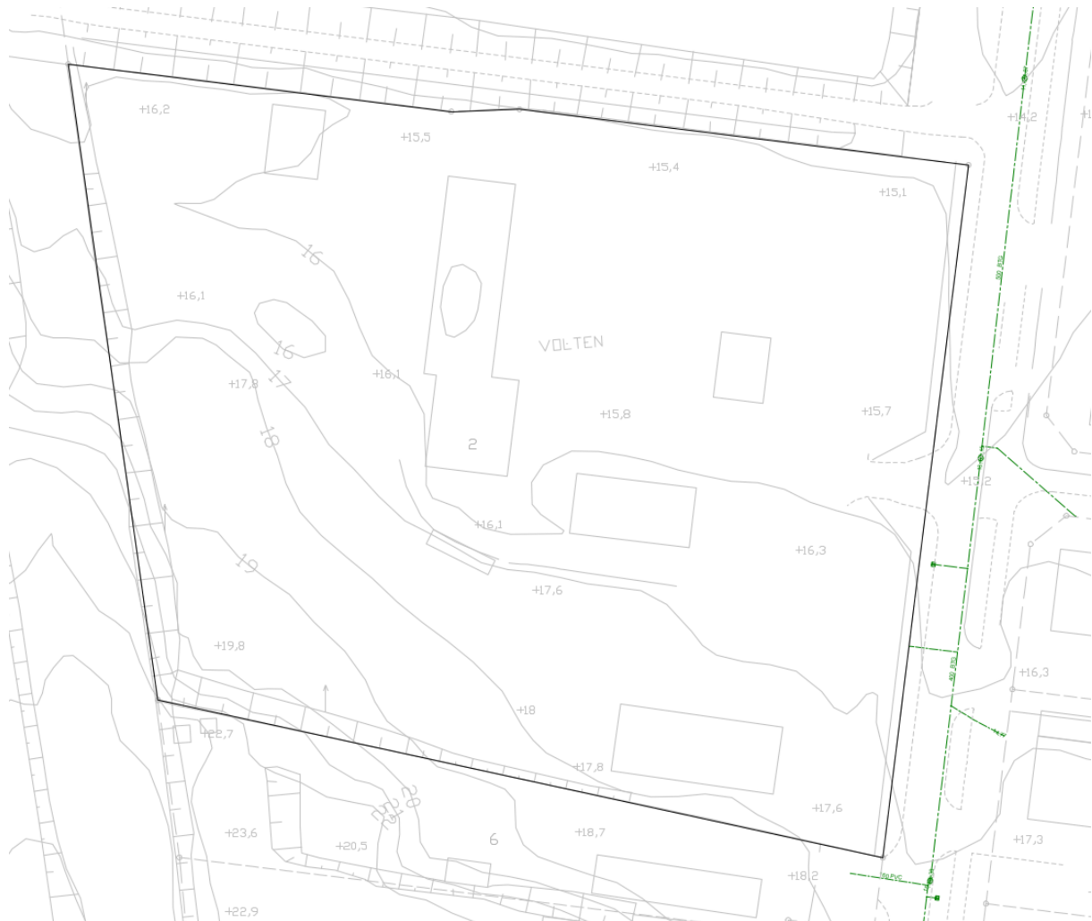
Figur 13. Befintliga dagvattenledningar i grönt kring planområdet utmärkt i svart, VA underlag från Skellefteå kommun (2023).
