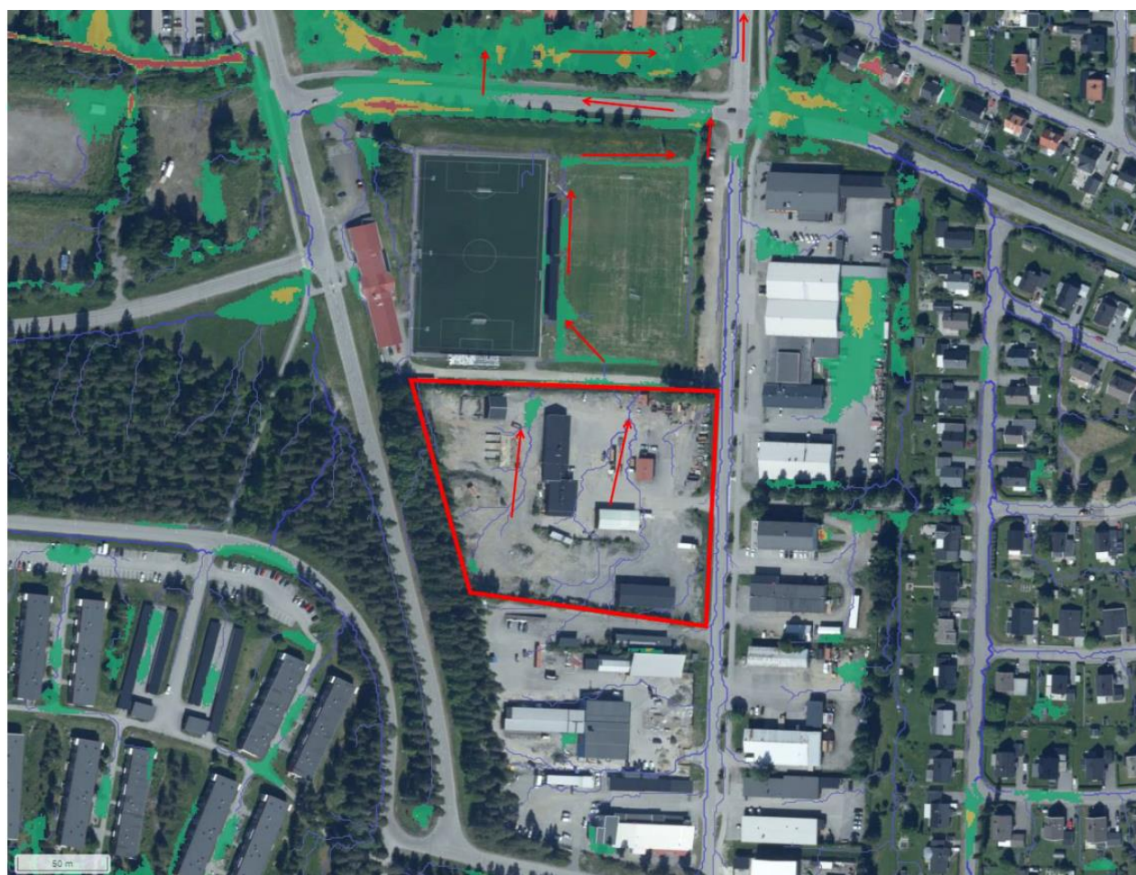
Figur 14. Vattenfyllda lågpunkter och rinnvägar inom planområdet vid befintlig höjdsättning, baserat på ett 100-årsregn. Gröna områden avser vattendjup <0,3 meter. Källa: WSP
