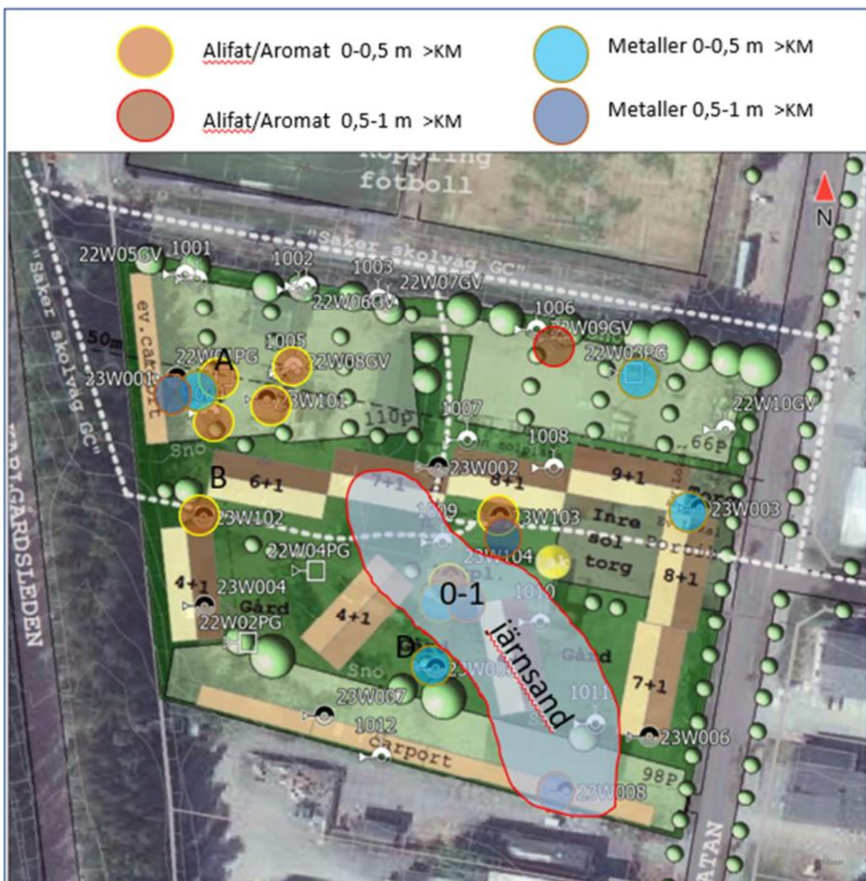
Figur 5. Läge av kartlagt område med järnsand. Källa: WSP
