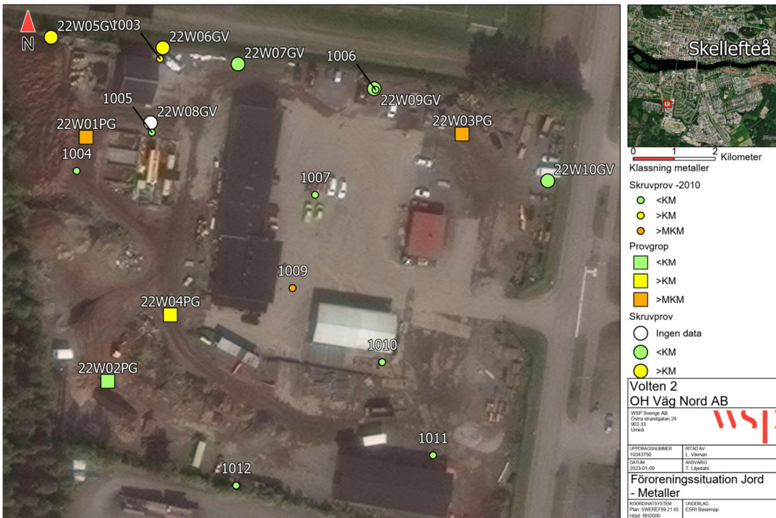
Figur 3. Föroreningsituation i jord avseende metaller.
