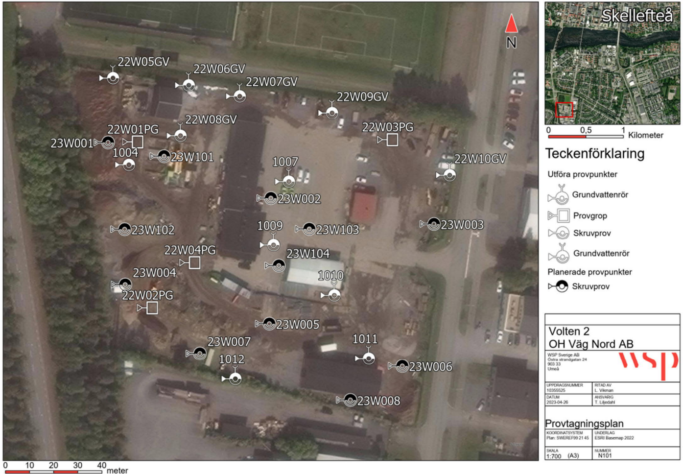
Figur 6. Provtagningsplan över grundvattenrör och provgropar (svarta symboler). Skruvprov och grundvattenrör märkta med 2010 (vita symboler) är från tidigare undersökning och ingår inte i denna provtagningsplan.
