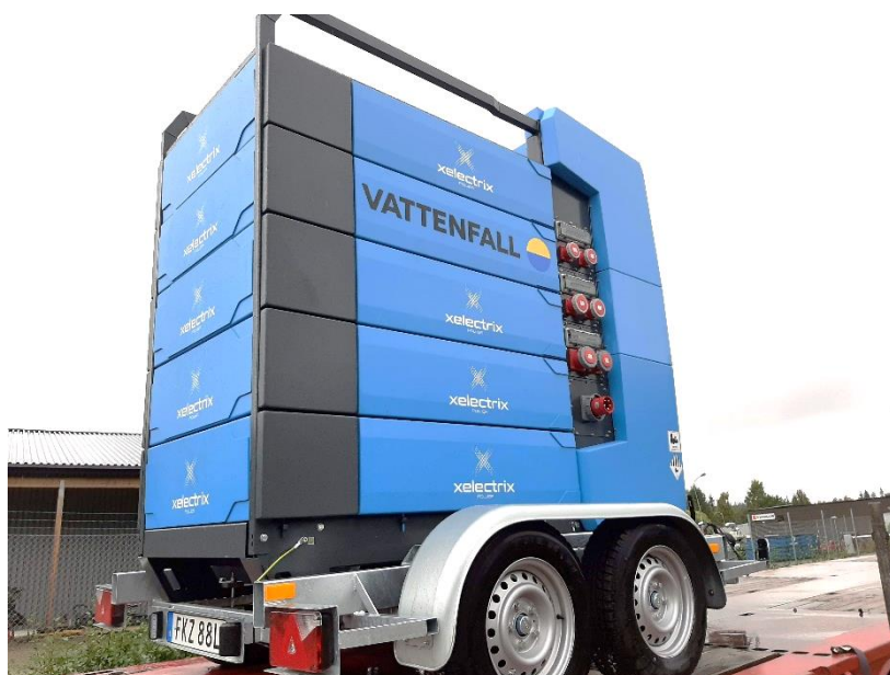
Bild 1 Det mindre energilagret (Typ 2) monterat på släpvagn. Foto: Daniel Marklund
