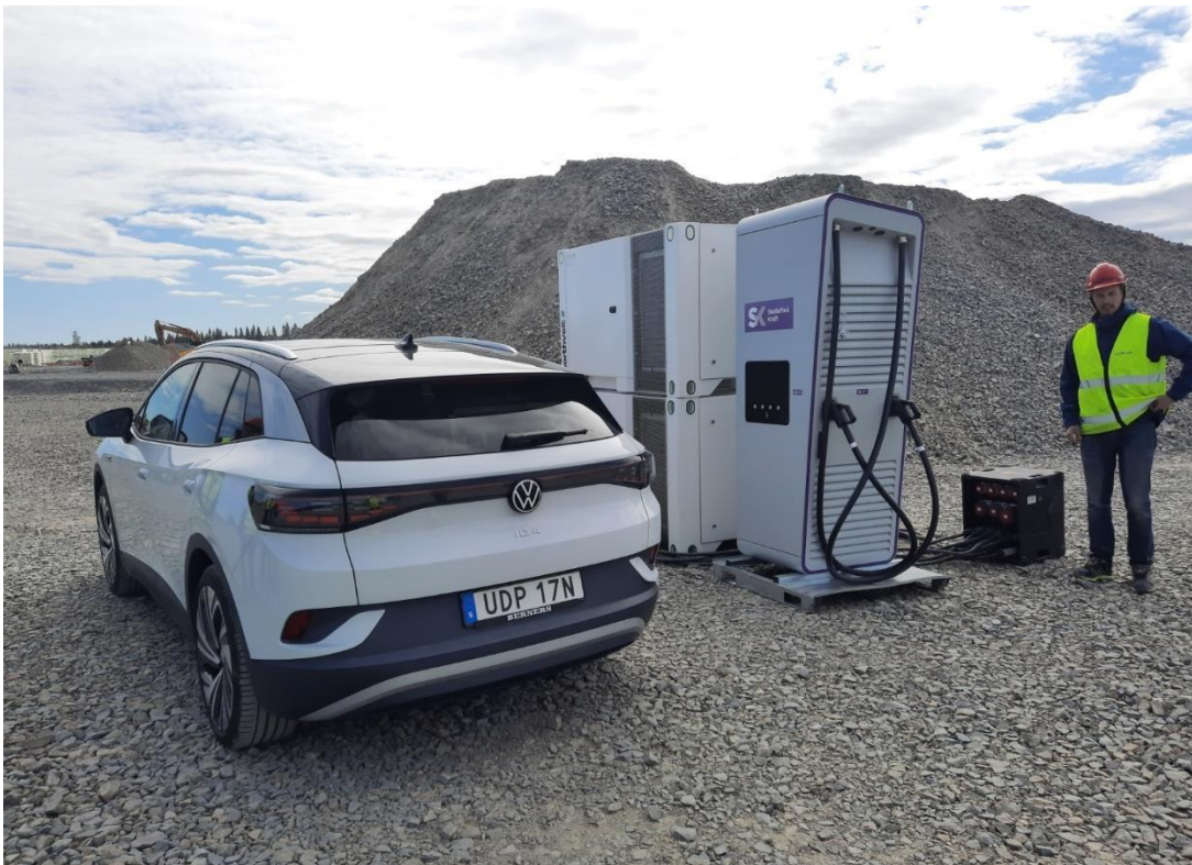
Figur 3: Energilagerenheterna, snabbladdaren och ID.4 (kopplingskåpet syns bakom laddaren).
