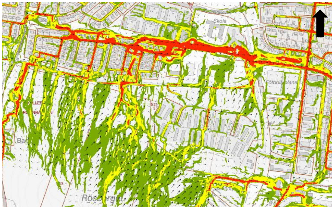
Figur 7. Flöden och hastighetsvektorer. Färgerna visar det beräknade maximala flödet. Vitt indikerar ett flöde på < 3 l/s/m. Grönt visar på ett flöde på 3–10 l/s/m, gult visar ett flöde på 10–25 l/s/m och rött ett flöde på >25 l/s/m.
