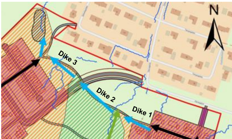
Figur 14. Schematisk gestaltning av föreslagen placering av svackdike.
