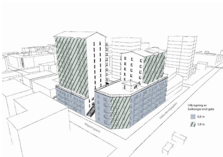
Figur 15. Illustration av högsta tillåtna utkravning av balkonger mot gata. Möjligheten att låta balkonger kraga ut högst 0,8 meter över gata syftar till att skapa en sammanhållen och enhetlig gestaltning. Balkonger och påbyggnader ska utformas så att de inte tar över eller dominerar fasadernas och byggnadens övergripande formspråk. Skellefteå kommun.
