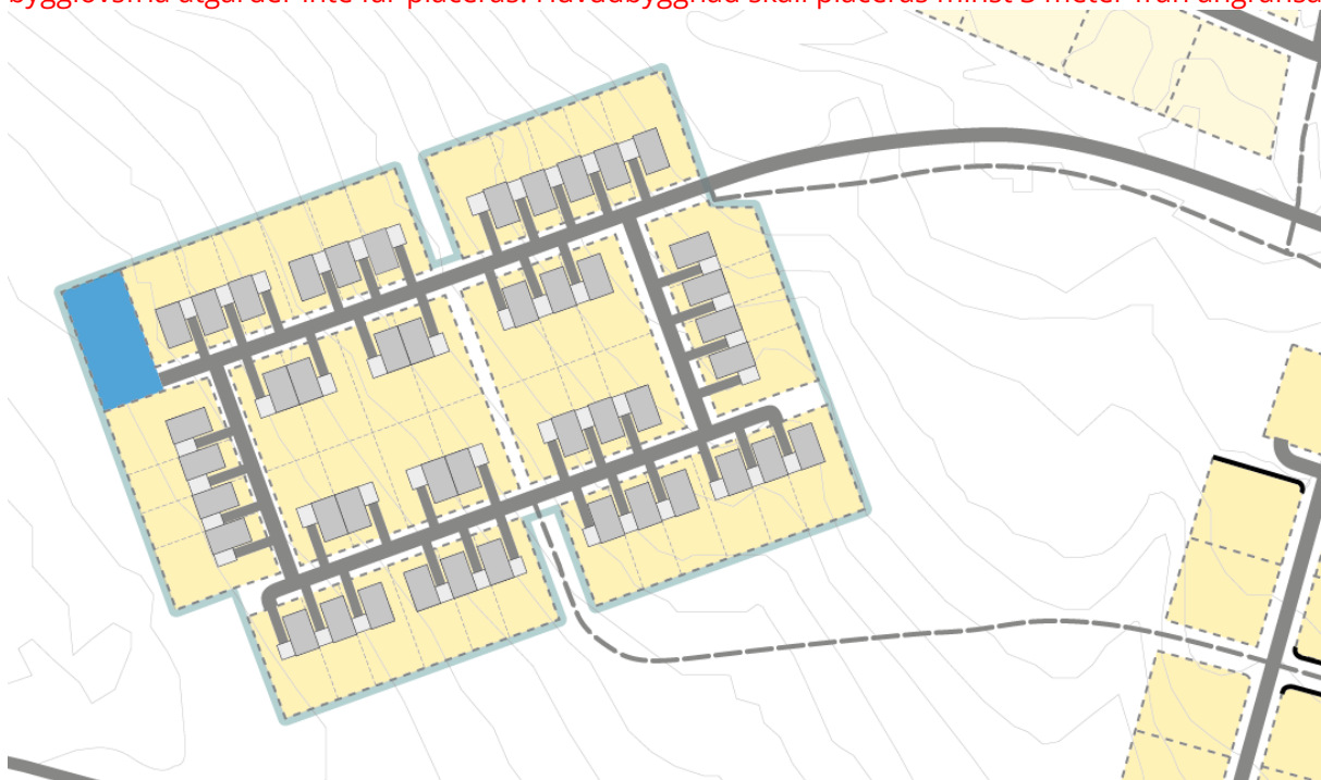
Figur 7. Illustration över lämplig placering av bebyggelse inom område 1 utifrån den förprojektering som genomförts av Sweco. Med denna lösning kan tillgänglighet uppnås och schaktning undvikas. Illustrationen visar också möjlig placering av snöupplag (blått), samt gräns för kvartersmark (grön linje)
